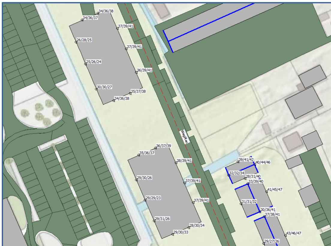
Afbeelding 6. Geluidbelastingen L_{den} (incl. aftrek art. 110g Wgh) Tilburgseweg (midden deel plangebied) Berekende geluidbelastingen op een hoogte van 1,5 / 4,5 / 7,5 meter
