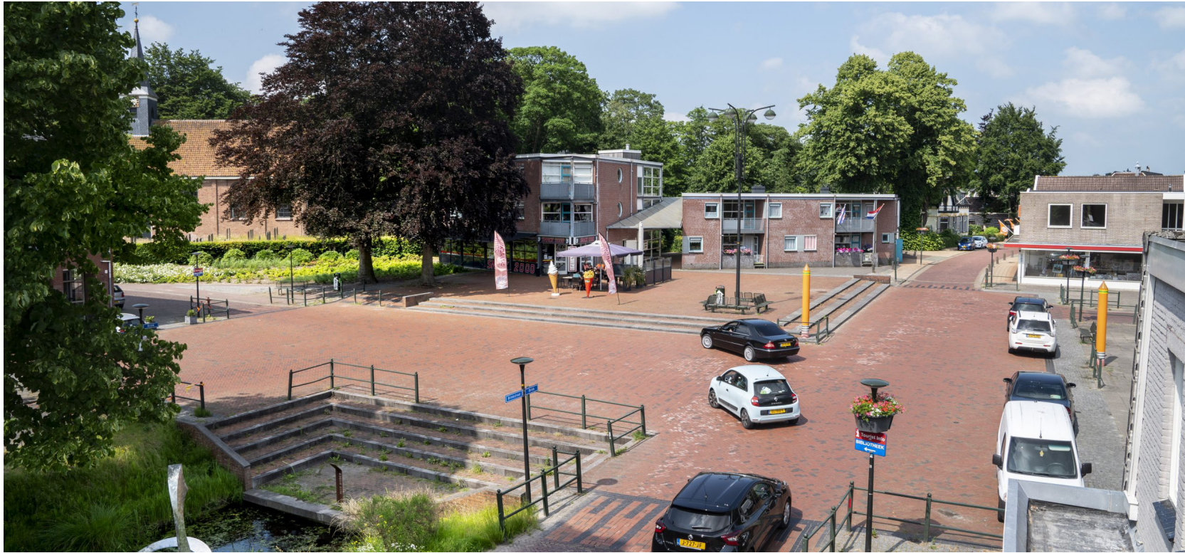
Shared Space voor fietsers en gemotoriseerd verkeer. Verblijfsruimte in zelfde materiaal maar geleiding aangebracht met klein niveauverschil
