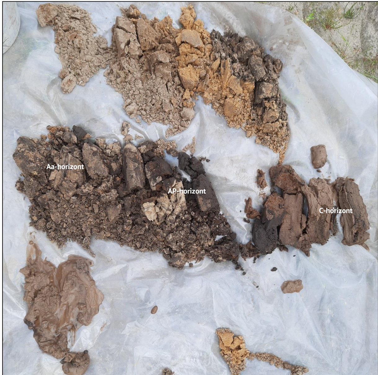
Figuur 8: Foto van boorprofiel boring 6 (0 – 160 centimeter). De leesrichting is van linksboven naar rechtsonder.
