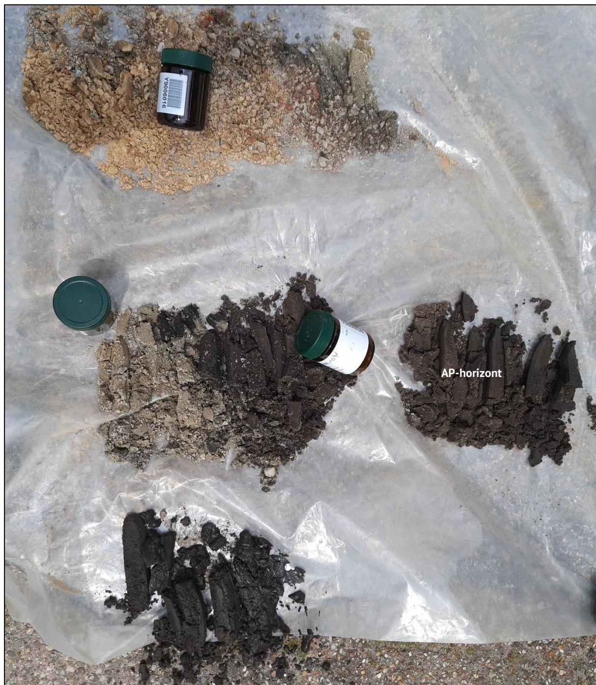
Figuur 7: Foto van boorprofiel boring 4 (0 – 220 centimeter). De leesrichting is van linksboven naar rechtsonder.
