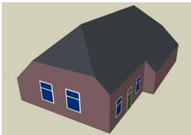
versmallig zijvleugel woonhuis, voordeur verplaatst
