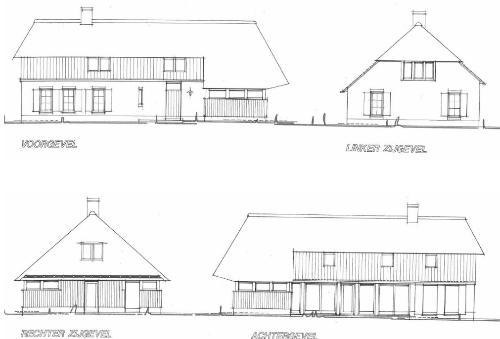
Impressietekeningen modernisering en uitbreiding bedrijfswoning.
