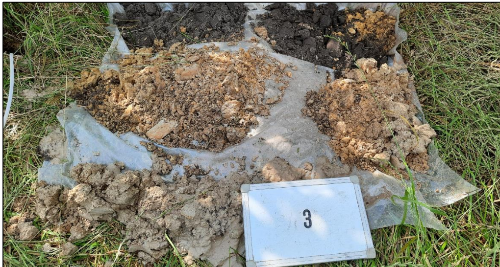
Afbeelding 3: Profielboring 3 vanaf maaiveld (linksboven) tot 2,6 meter onder maaiveld (rechtsonder).
