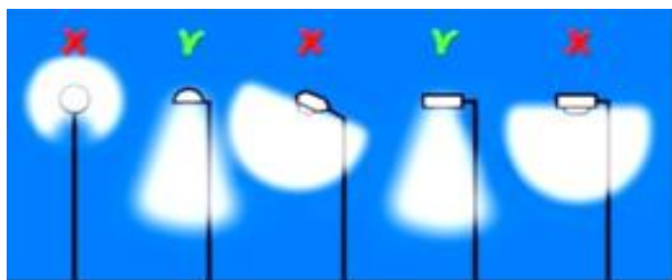
Figuur 10 Het voorkomen van lichtverstrooiing door aangepaste armatuur.
