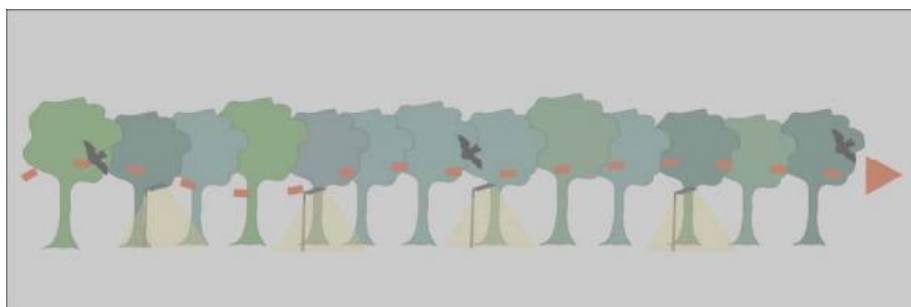
Figuur 9 Voorkomen van verstrooiing door de hoogte van de lichtmasten aan te passen (bron: Herman Limpens)
