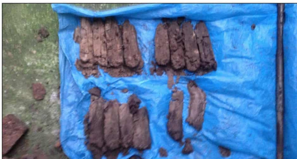
Boring 2: 0-170 cm -Mv. Dieper gelegen materiaal liep uit de boor door de hoogte van het grondwaterpeil.
