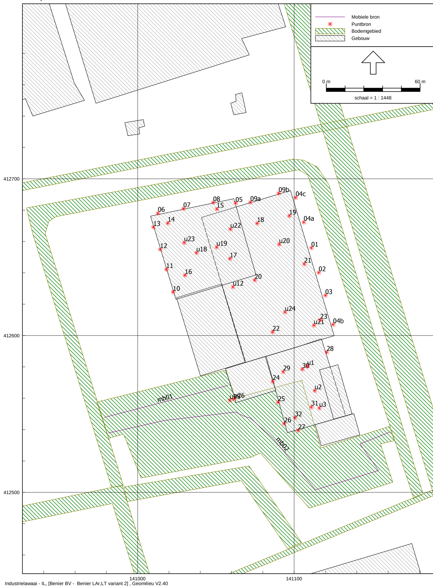
figuur 5b: rekenmodel positie geluidbronnen uitvoeringsvariant II
