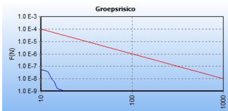
Figuur 6 FN-curve van de kilometer met de hoogste overschrijdingsfactor van het beschouwde gedeelte van gastransportleiding Z-517-04 in de huidige situatie. De ligging van deze kilometer is hiernaast in het groen weergegeven op een topografische kaart.
