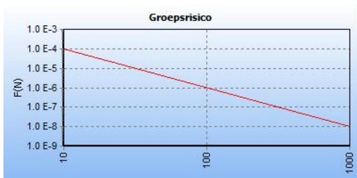
Figuur 6 FN-curve van de kilometer met de hoogste overschrijdingsfactor van gastransportleiding Z-517-05 in de huidige situatie. De ligging van deze kilometer is hiernaast in het groen weergegeven op een topografische kaart.
