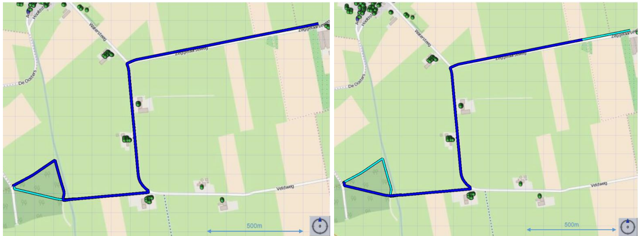
Figuur 1 Ligging van gastransportleiding Z-517-05. De ligging van de leiding in de huidige situatie is in de linker afbeelding weergegeven in het donkerblauw, en de leiding na de verlegging is in de rechter afbeelding in het donkerblauw weergegeven
