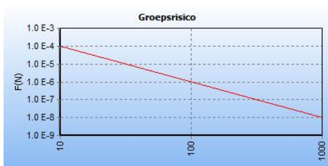
Figuur 8 FN-curve van de kilometer met de hoogste overschrijdingsfactor van gastransportleiding Z-517-05 in de toekomstige situatie. De ligging van deze kilometer is hiernaast in het groen weergegeven op een topografische kaart.
