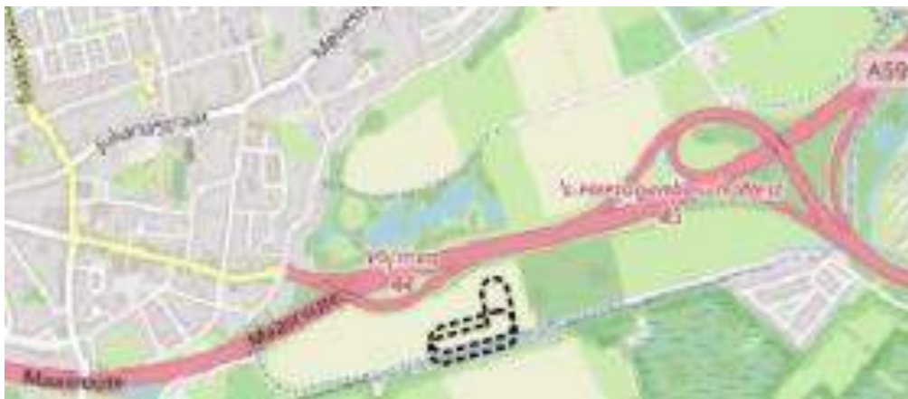
Figuur 3-5 de contouren van de berekende reikwijdte van de bemaling (bron: bemalingsadvies 25 februari 2020)
