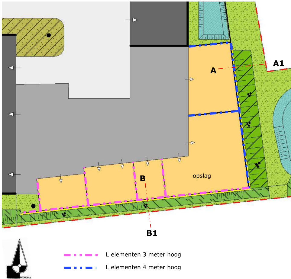
Bouwkundige details : Grondkeringen schaal 1-500
