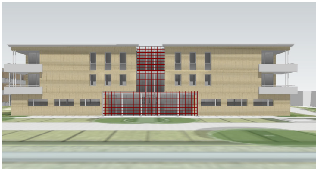
f6.3 Weergave geveldeel uit te voeren met WBDBO van 30 minuten (rood gearceerd)
