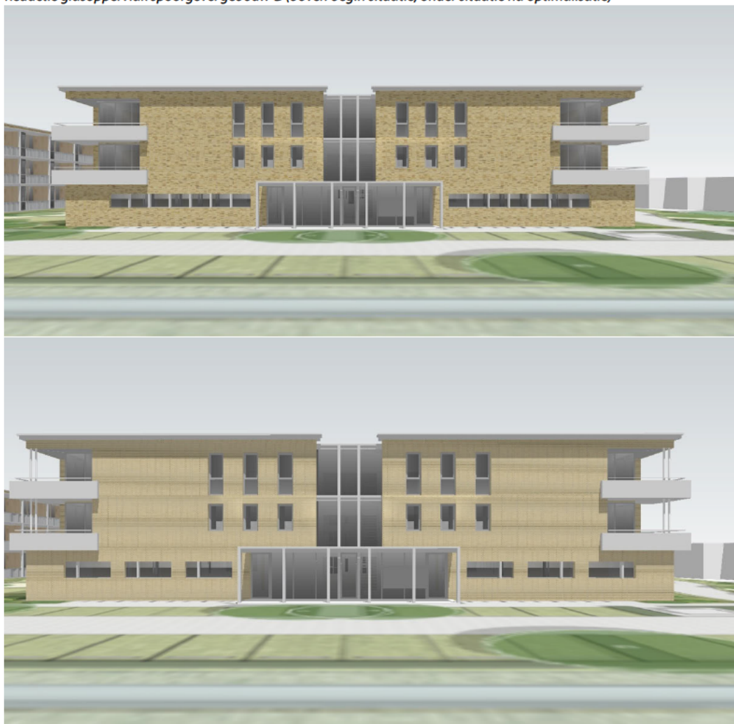
f6.2 Reductie glasoppervlak spoorgevel gebouw B (boven begin situatie, onder situatie na optimalisatie)
