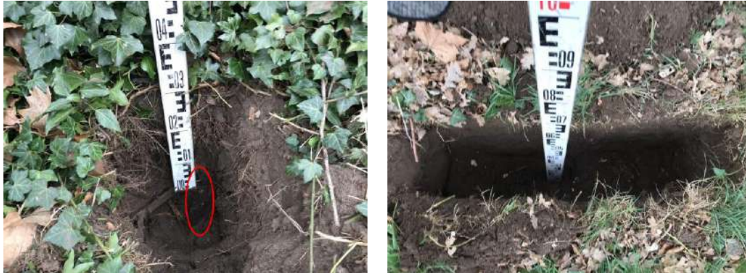
Figuur 7 Proefsleuf 1 (links) met stabiliteitswortel omcirkeld, en proefsleuf 2 (rechts).
