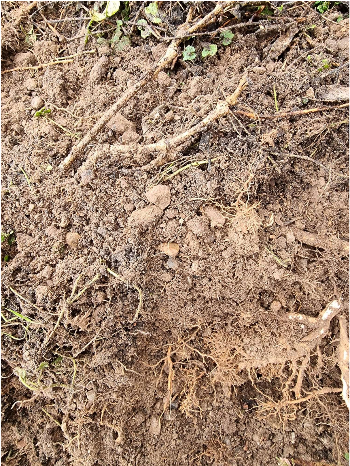
Foto Haarwortels in bovenlaag halfverharding, opgereden deel op 7 meter vanuit de waterlijn.
