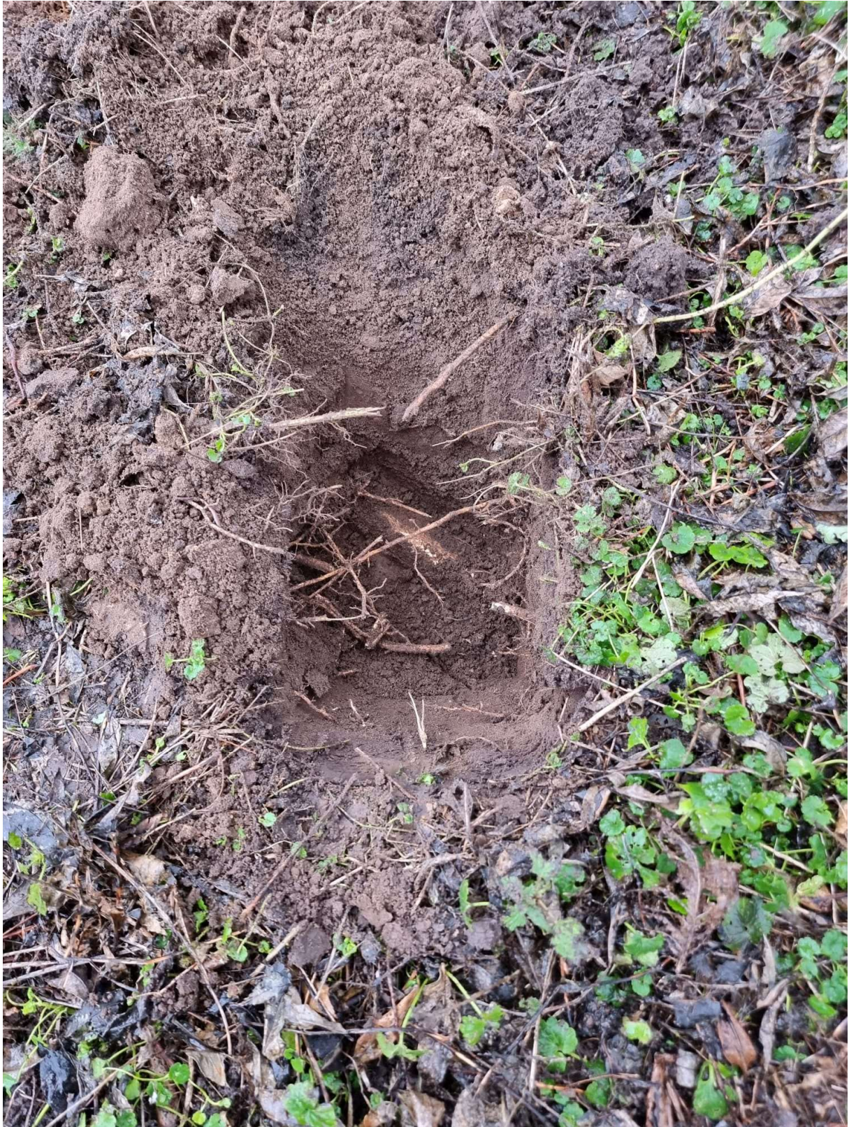
Foto: Proefsleuf in traject A1 – B. Haarwortels en wortel > 3 cm. Waargenomen op 7 m1 uit de waterlijn.
