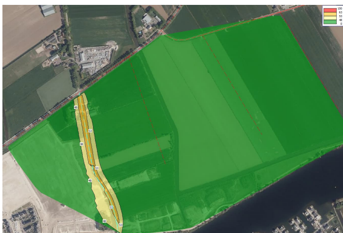
Figuur 7.4 | Geluidbelasting vanwege de Rosmalensedijk
