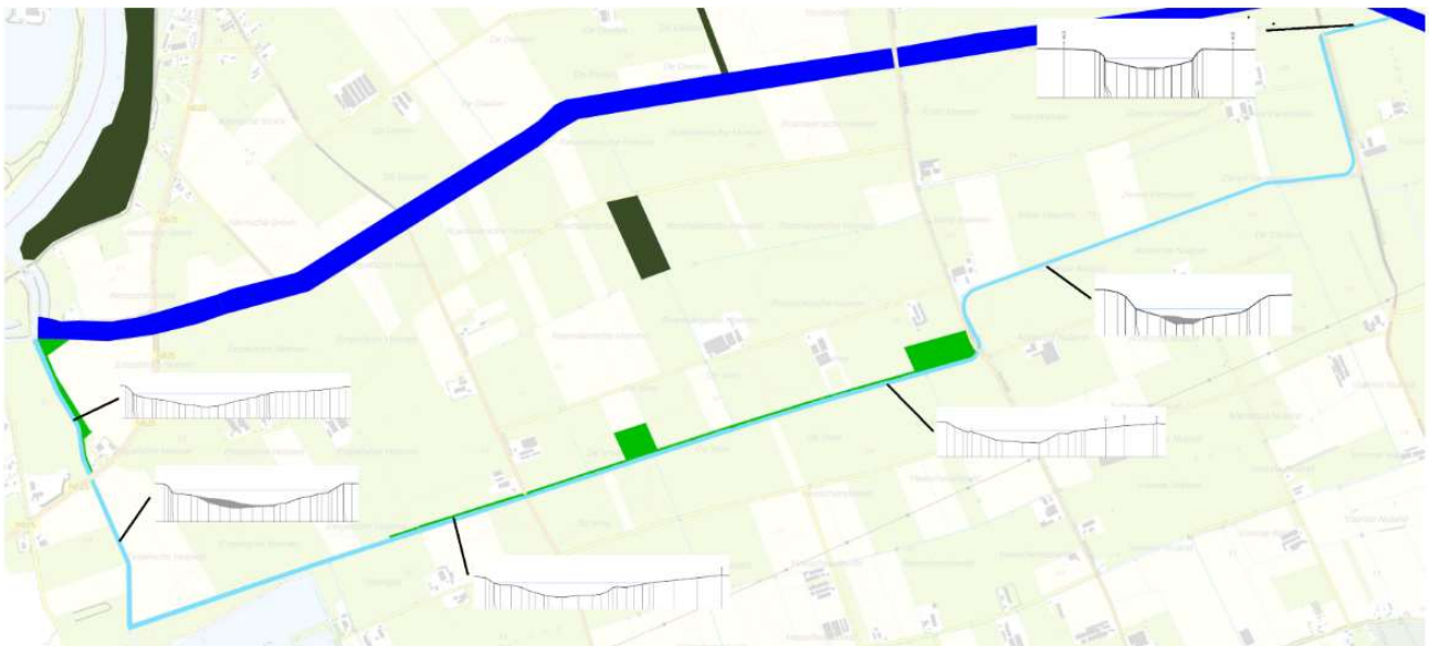
Fig. 2: Huidige Hoefgraaf met profielen van de watergang
