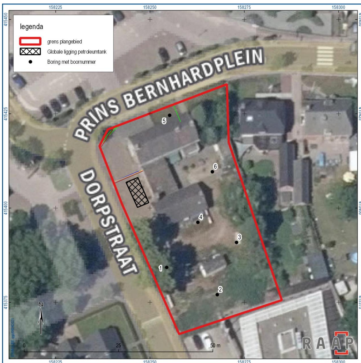
Figuur 8. Luchtfoto plangebied met de locatie van de boringen en de globale ligging van de petroleumtank. De kabels en leidingen zijn aangegeven met de gekleurde lijnen.
