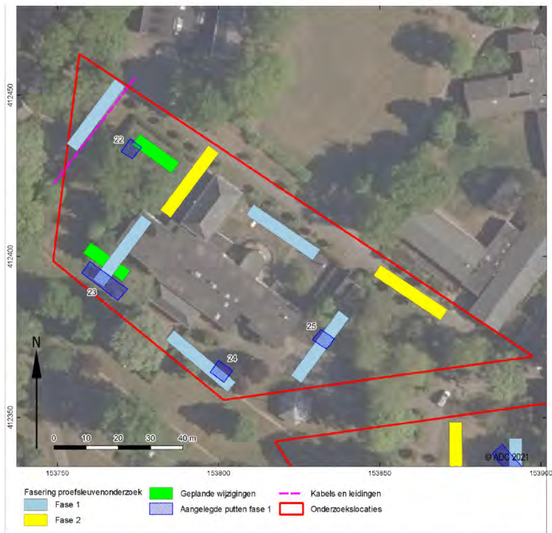
Afb. 9 Locatie van de proefsleuven in het zuidelijk deel van landgoed zone 8, ten opzichte van de oorspronkelijk geplande sleuven.
