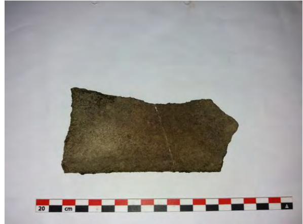
Foto asbestverdacht materiaal nabij boring 1
