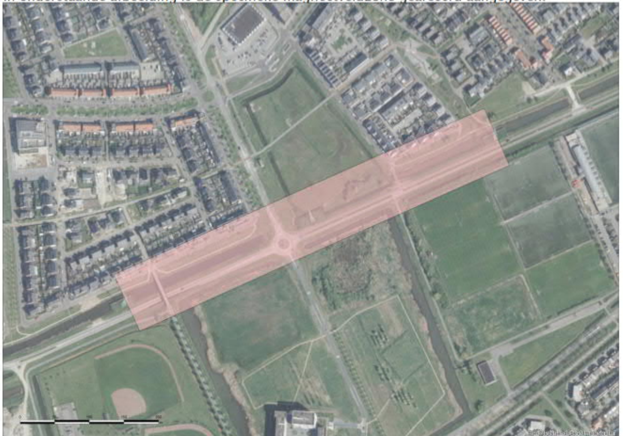
Figuur 2 De berekende specifieke magneetveldzones tussen de masten 18 en 20
