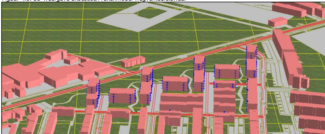
Figuur 4.1: 3D-weergave akoestisch rekenmodel wegverkeerslawaaï
