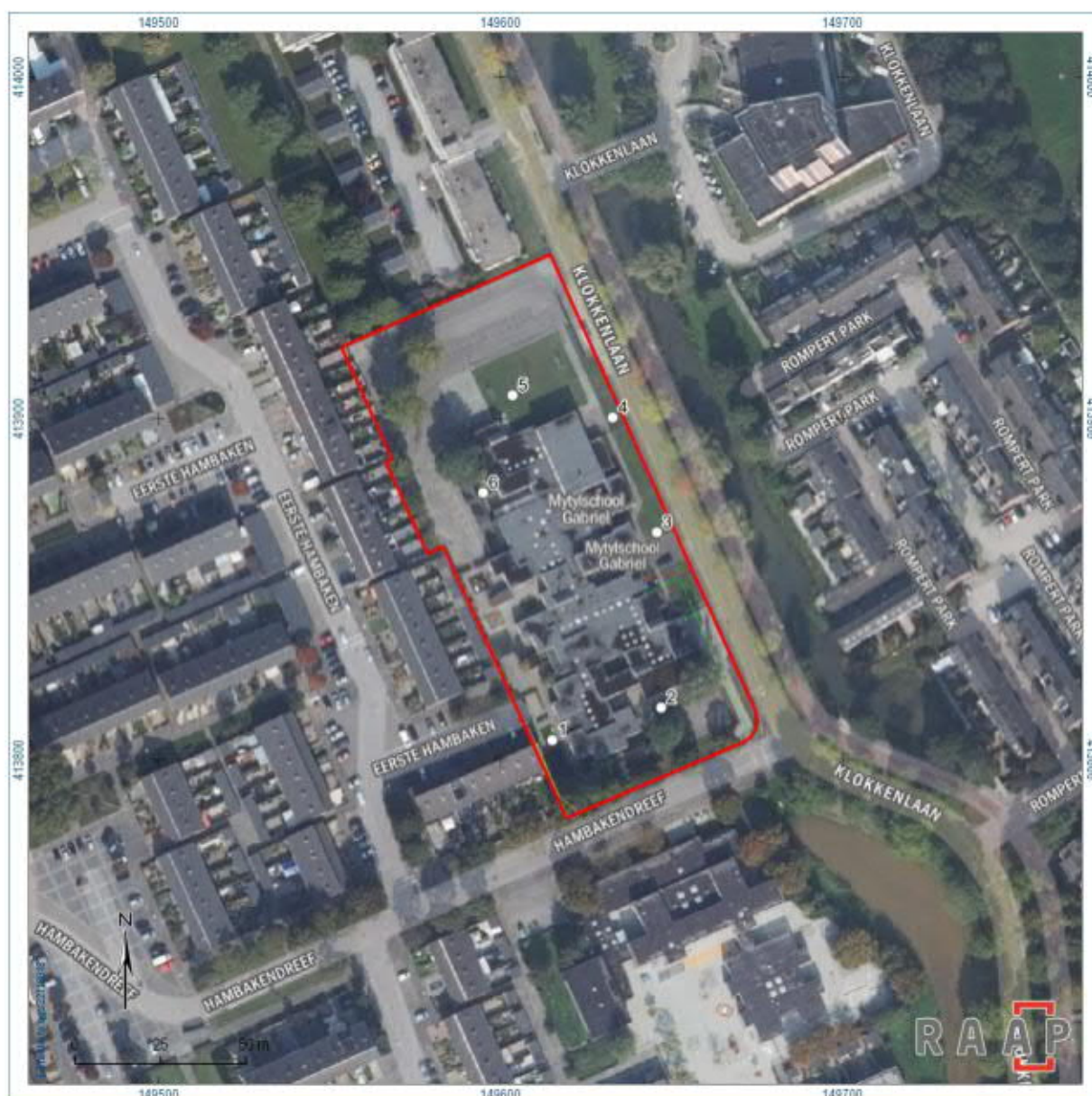
Figuur 4. Overzicht van de boorlocaties (genummerd) in het plangebied (rood), afgestemd op de bebouwing, verharding en kabels en leiding (dunne groene lijnen).
