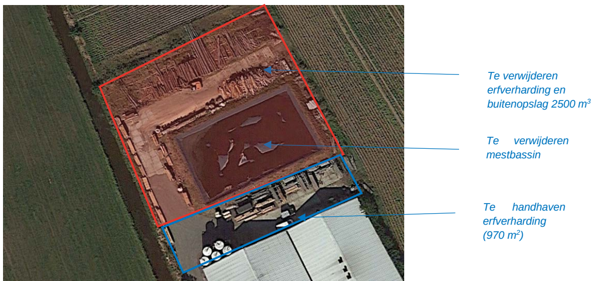
Figuur 3-3 overzicht achtererf en gewenste bedrijfsindeling erfverharding
