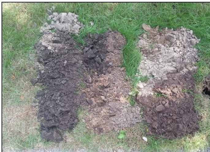
Figuur 5a: Zicht op boring 2, uitgelegd van rechtsonder naar linksboven (foto genomen tijdens booronderzoek d.d. 28 augustus 2018).
