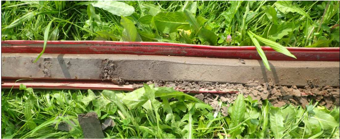
Boring 16: klei top op het dekzand. In het dekzand is een humeuze bovengrond (donkergrijs) aanwezig.
