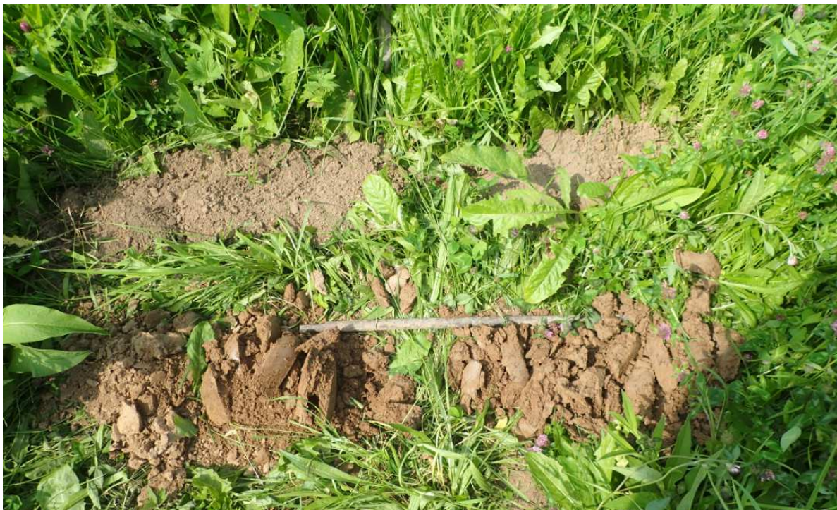
Boring 16; tot 2,0 m -Mv overslagafzettingen.
