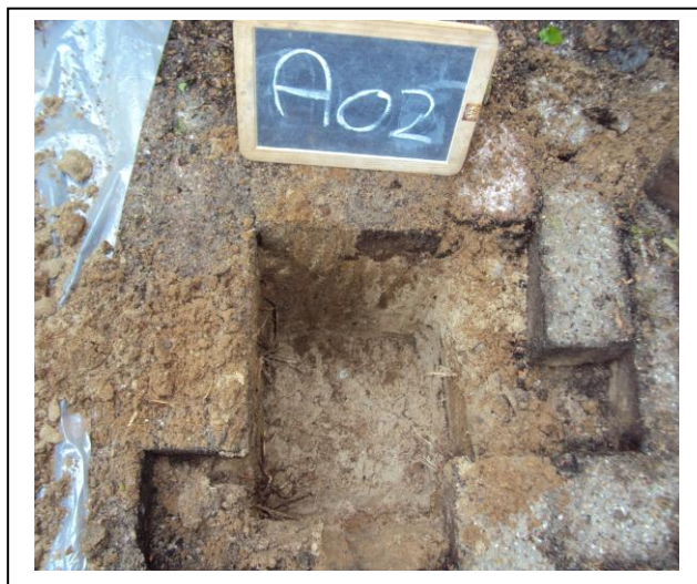
Foto asbestinspectiegat A02
