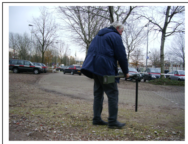
Fig. 4 testonderzoek met magnetometer ter plaatse
