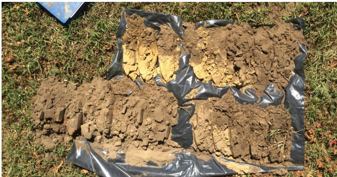
Opname van boring 2. Verstoringsdek op dekzand.
