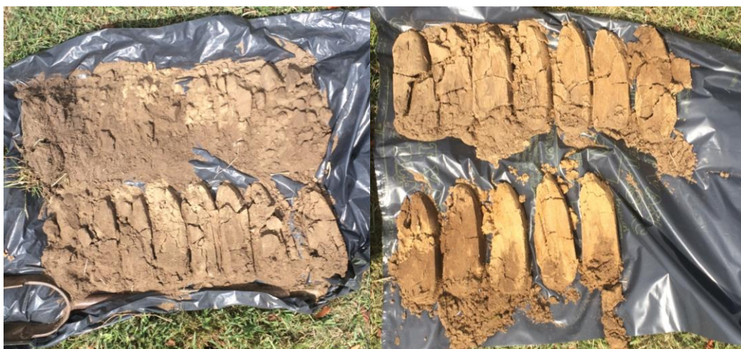
Opname van boring 5. In de top van het pleistocene zand is een humeuze, roestige Ah-horizont aanwezig.
