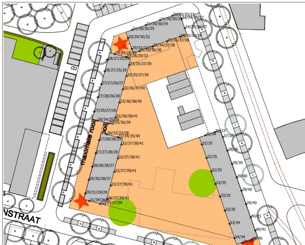
f4.9 Geluidbelastingen L_{etmaal} in dB(A) vanwege rangeerterrein, planvariant E1A
