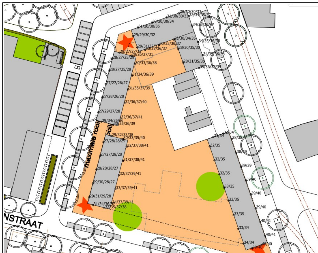
f4.15 Geluidbelastingen L_{etmaal} in dB(A) vanwege rangeerterrein, planvariant E2A
