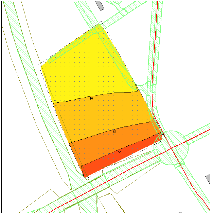
Figuur 2.2: Geluidcontouren ten gevolge van wegverkeer op de Bruistensingel, 4,5 meter boven maaiveld. Binnen het gele vlak wordt voldaan aan de voorkeursgrenswaarde van 48 dB.
