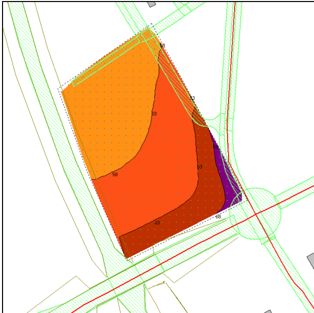
Figuur 10 Gecumuleerde geluidcontouren op 4,5 meter boven maaiveld met Blauwe Sluisweg 50 km/uur
