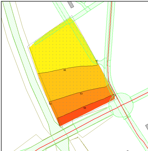
Figuur 4 Geluidcontouren ten gevolge van het wegverkeer op de Bruistensingel op 4,5 m boven maaiveld
