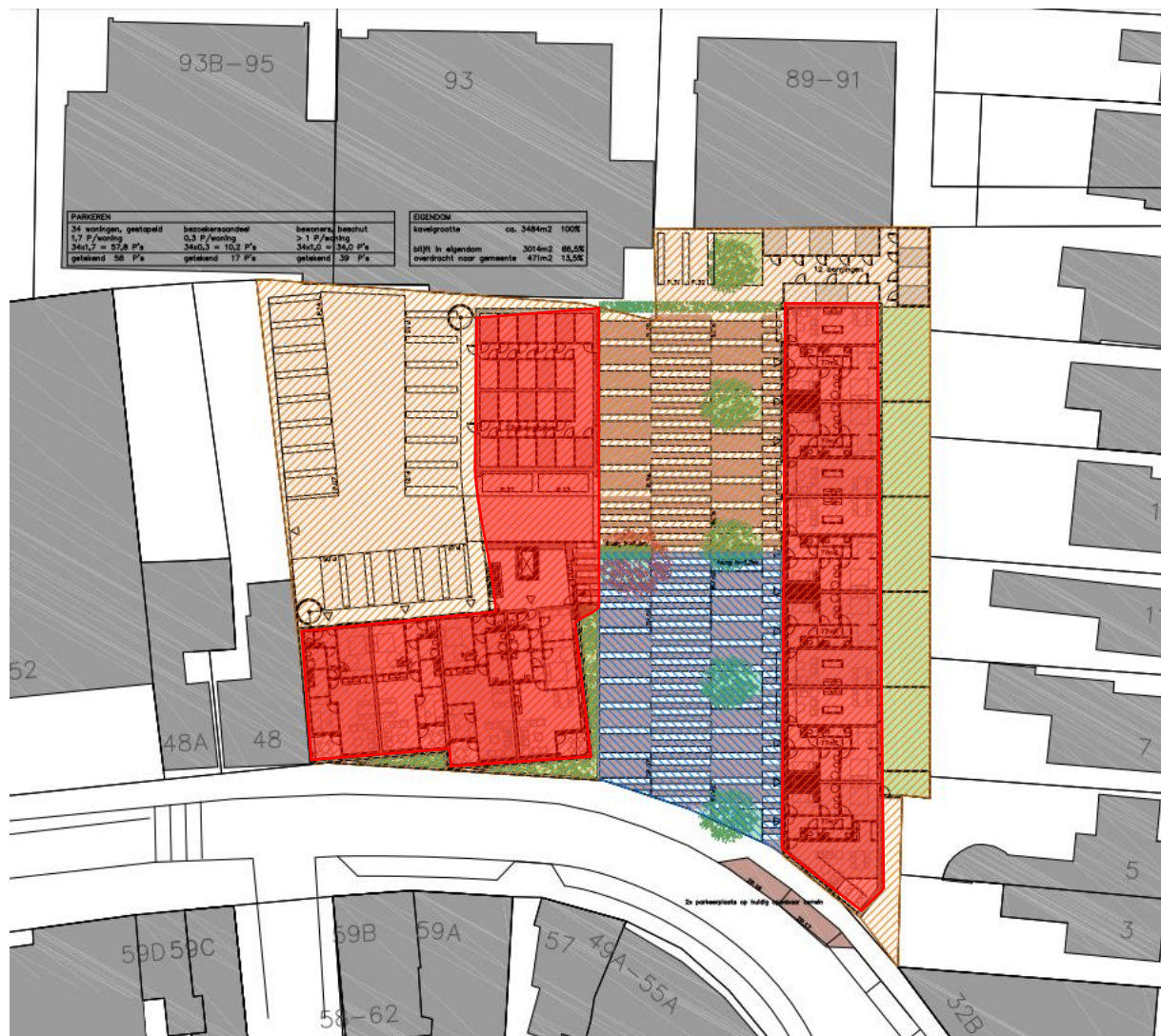
Figuur 1.3 Ontwerp toekomstige situatie (bron: Pauwert Architectuur B.V.), met in rood het toekomstig dakoppervlak, in groen het onverhard oppervlak en in bruin gearceerd de toekomstige terreinverharding.
