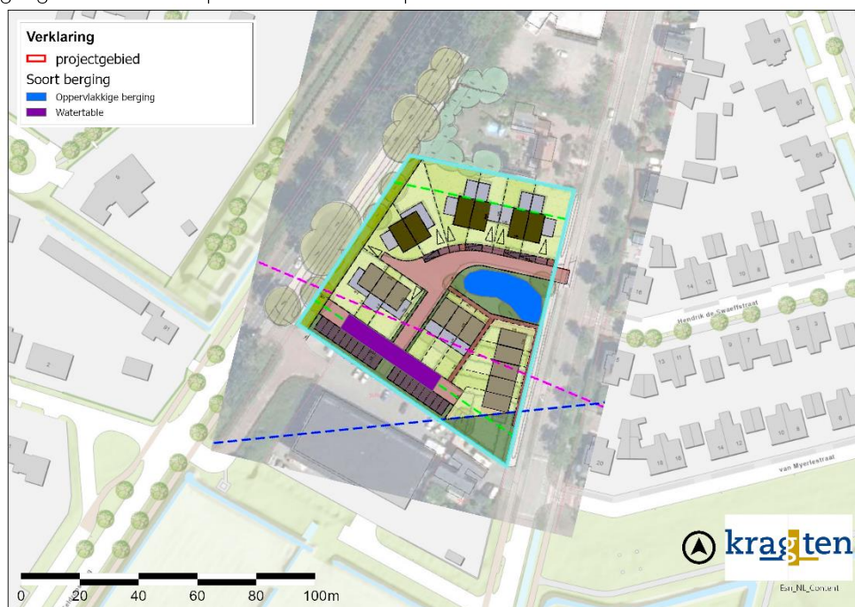
Figuur 11 Indicatie ruimtebeslag infiltratiekragen
