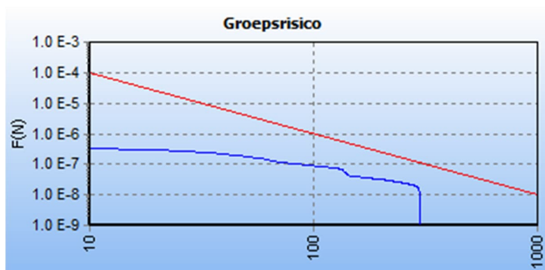
Afbeelding 6 fN-curve buisleiding A-521-deel-1, huidige situatie
