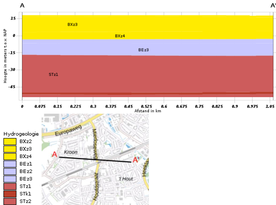
Figuur 6: Geohydrologische doorsnede
