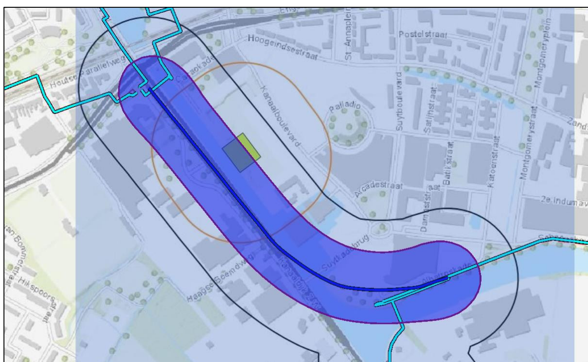
Figuur 4.2 Plaatsgebonden risico buisleiding: 10 -8 p.j. (blauw)
