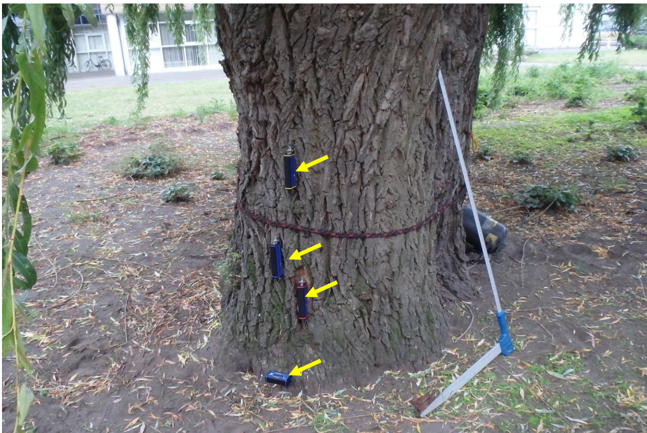
Foto 2: Positie van sensoren tijdens het trekken (gele pijlen).
