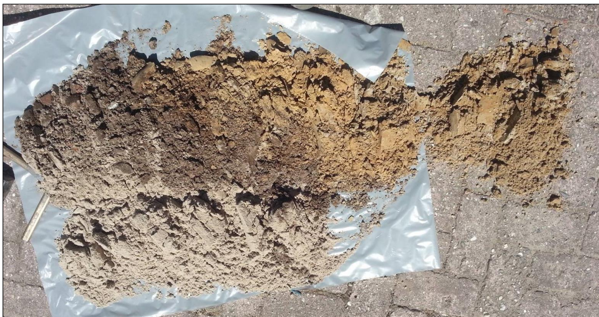
Figuur 5: Het boorprofiel van boring 6. De leesrichting is van linksonder naar rechtsboven (0-130 cm –mv).
