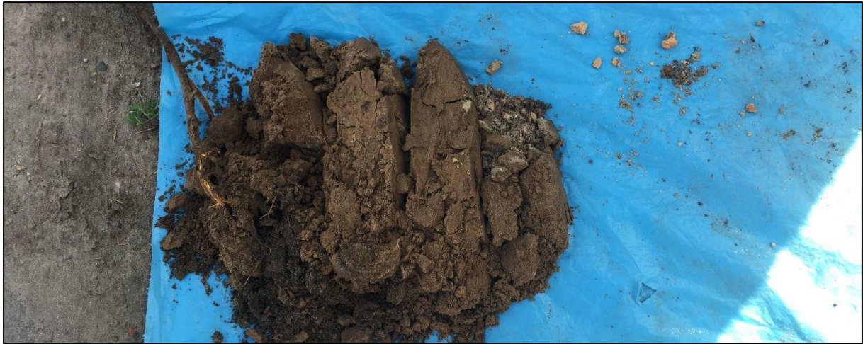
Boring 4: 0-45 cm -Mv. Boring meermaals gestaakt in leiding, puin of fundering.
