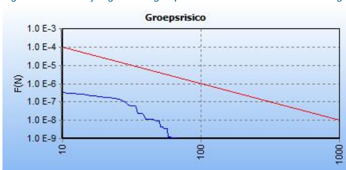
Figuur 10: FN-curve van de kilometer met de hoogste overschrijdingsfactor van gastransportleiding Z-542-01 in de huidige situatie. De ligging van deze kilometer is hiernaast in het groen weergegeven op een topografische kaart.
