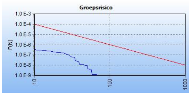
Figuur 12: FN-curve van de kilometer met de hoogste overschrijdingsfactor van gastransportleiding Z-542-01 in de toekomstige situatie. De ligging van deze kilometer is hiernaast in het groen weergegeven op een topografische kaart.
