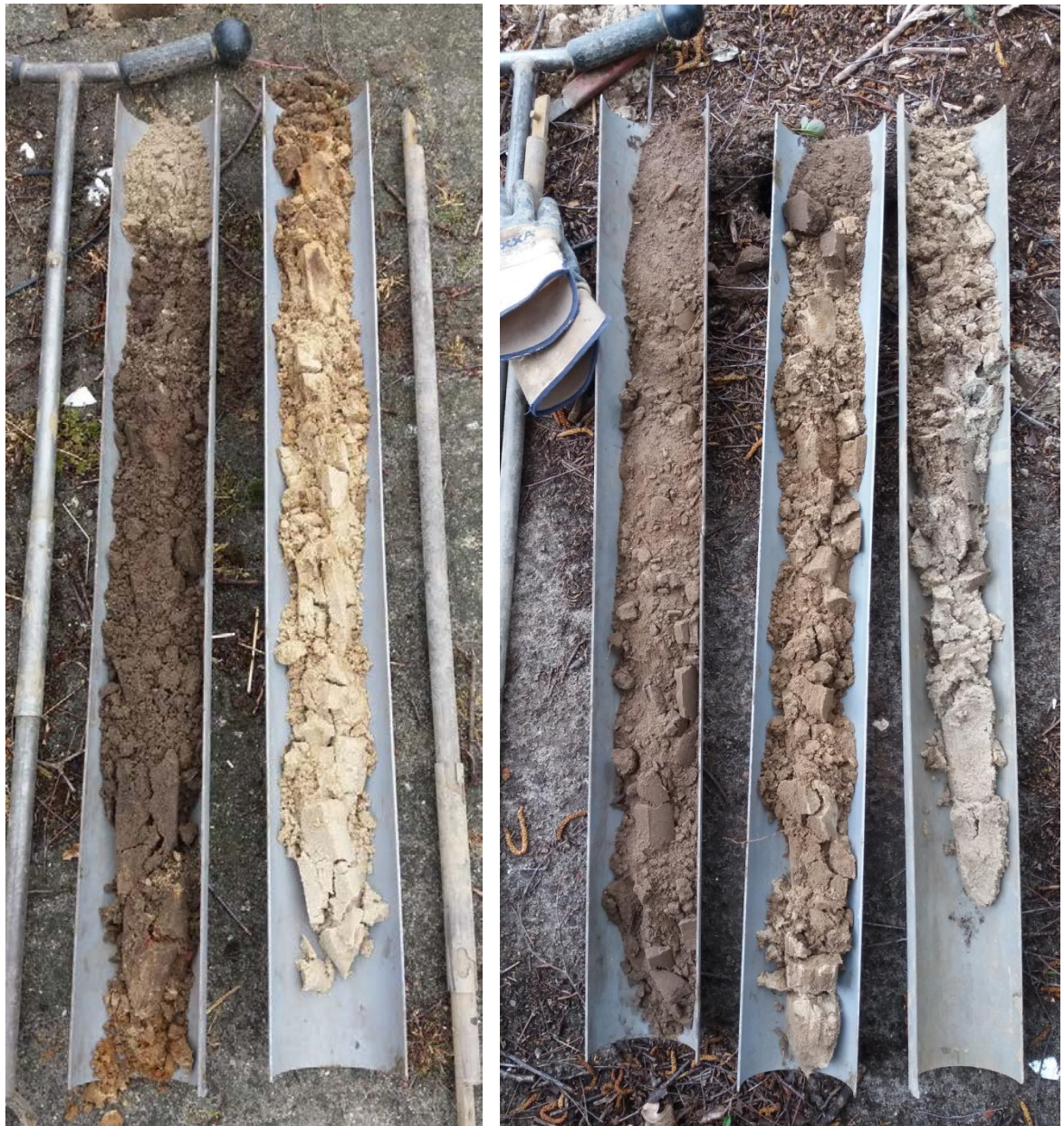
Fig. 3.1: Opgeboorde sediment van boring 2 (links) en boring 3 (rechts).
