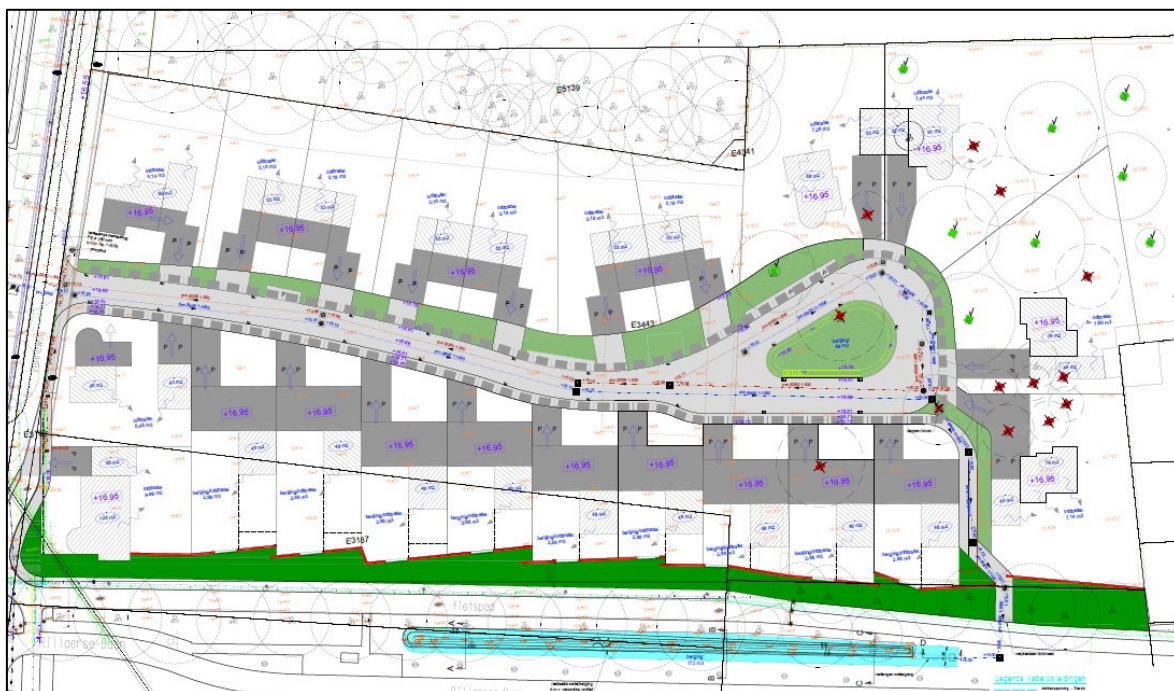
Fig. 11. Waterhuishoudingskundig plan april 2019 (blauw = WRA leiding, grijze blokken = nutstracé) plus te verwijderen bomen (rood).
