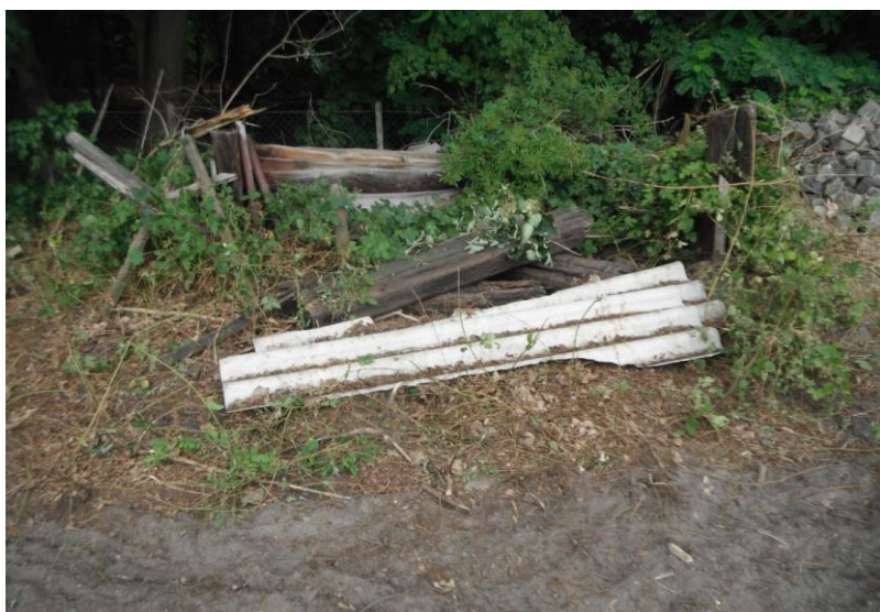
Afbeelding 3: Asbestverdacht plaatmateriaal op het maaiveld ter hoogte van boring 9.
