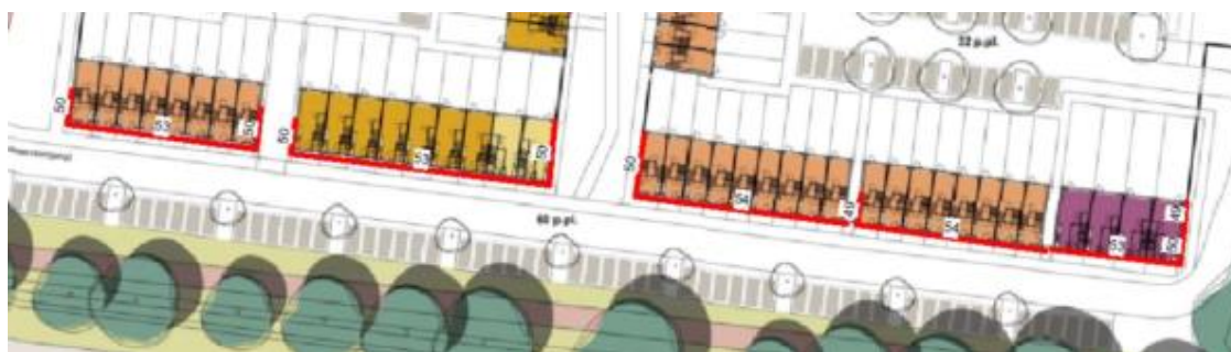
Figuur 12 geveldelen met overschrijding van de ten hoogste toelaatbare geluidsbelasting. Bron: Econsultancy, 2024.
