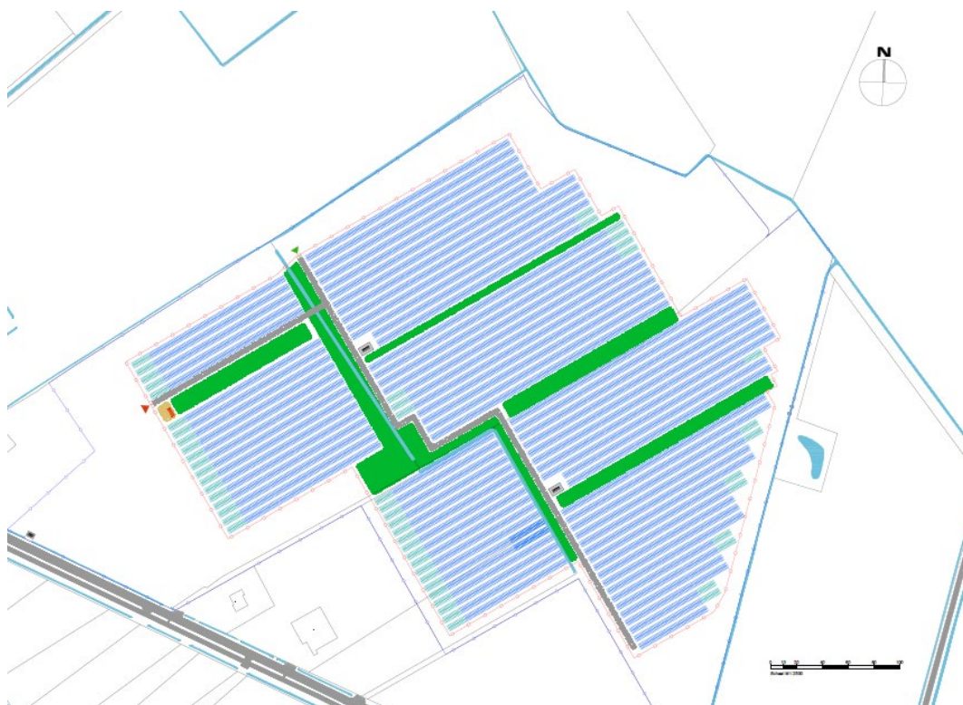
Afbeelding 3.1 Uitsnede technische tekening plangebied, voor de volledige weergave zie Bijlage 6 Technisch ontwerp (Bron: TPSolar)
