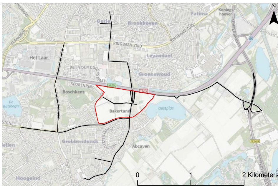
Figuur 3-2 Wegennetwerk voor Bakertand in de autonome situatie. De wegen (zwart) zijn meegenomen binnen het plangebied (rood) en erbuiten totdat het verkeer is opgegaan in het huidige verkeersbeeld. Er is alleen met dit verkeersmodel gerekend voor de vergelijking met de gebruiksfase. Ondergrond: OpenTopo achtergrondkaart, PDOK
