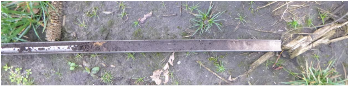
Figuur 25: Foto van de bouwvoor (links) met daaronder de AC-horizont (midden) en geheel rechts de C-horizont van ongeoxideerd, grijs zand.
