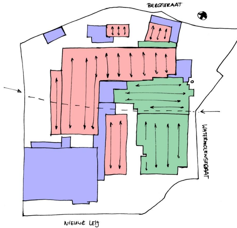
Afbeelding 3.27 Dakenlandschap van het Van Puijenbroekcomplex. Blauw zijn platte daken, rood de sheddaken en groen zijn zadeldaken.
