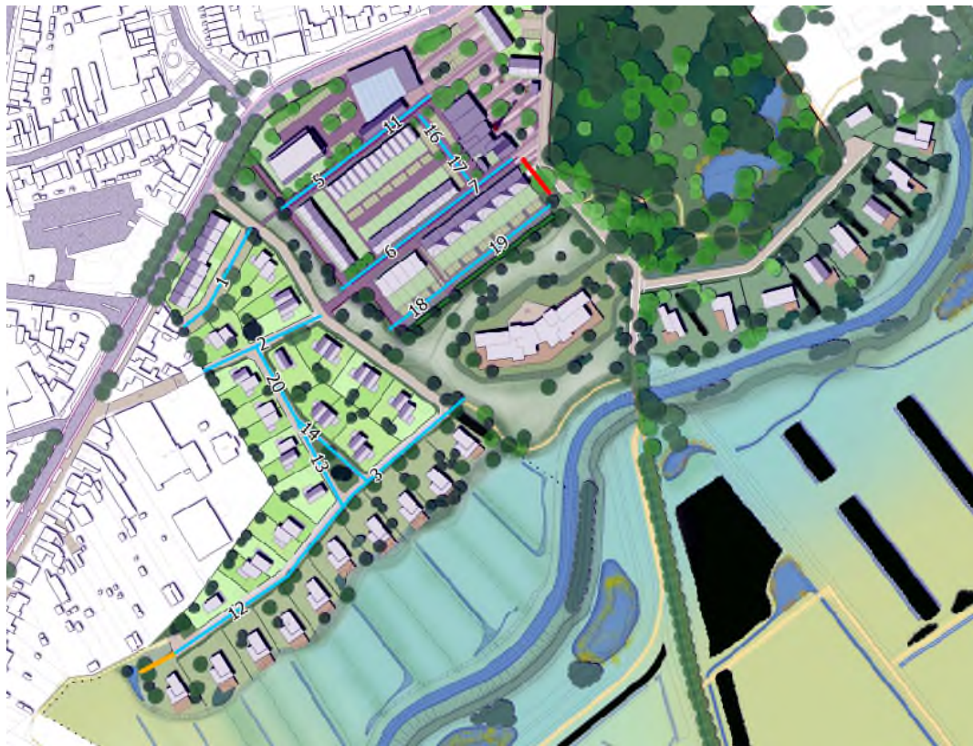
Figuur 5: Indicatie van gotenstructuur inclusief nummering (lichtblauw), met in oranje greppel naar waterberging en in rood de overloop van het Waterplein)
