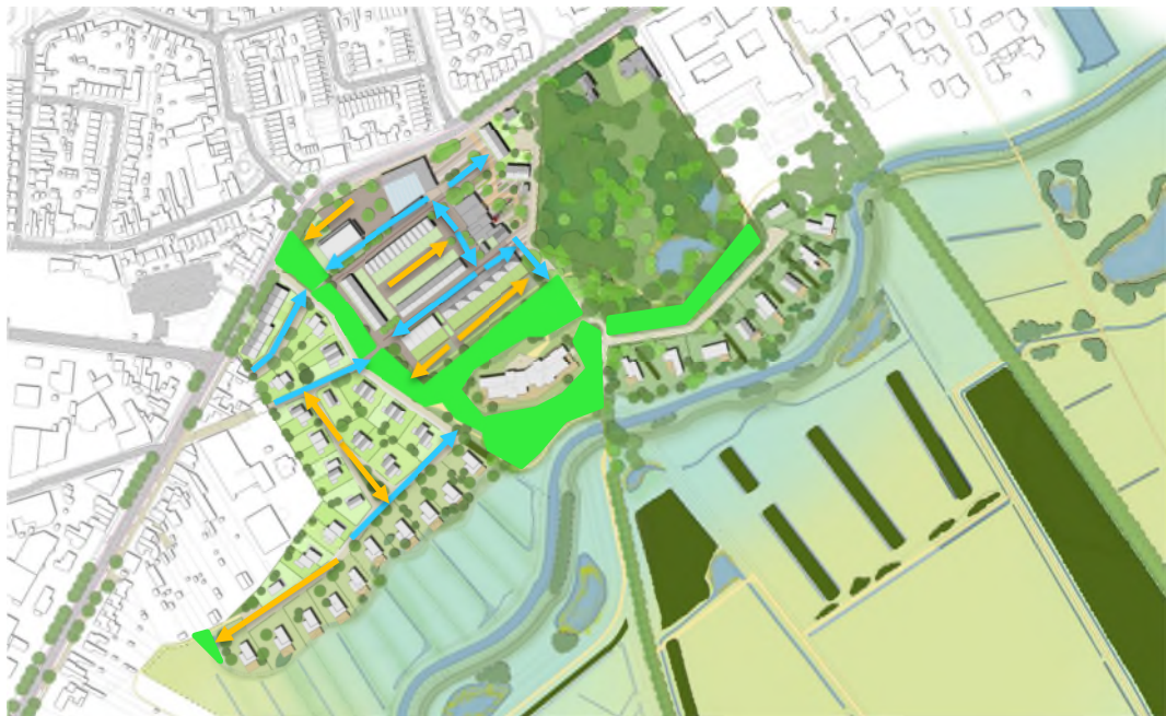
Figuur 9: Bovengrondse stroomrichting door goten (blauwe, gele, rode pijlen) met waterberging (groene vlakken)
